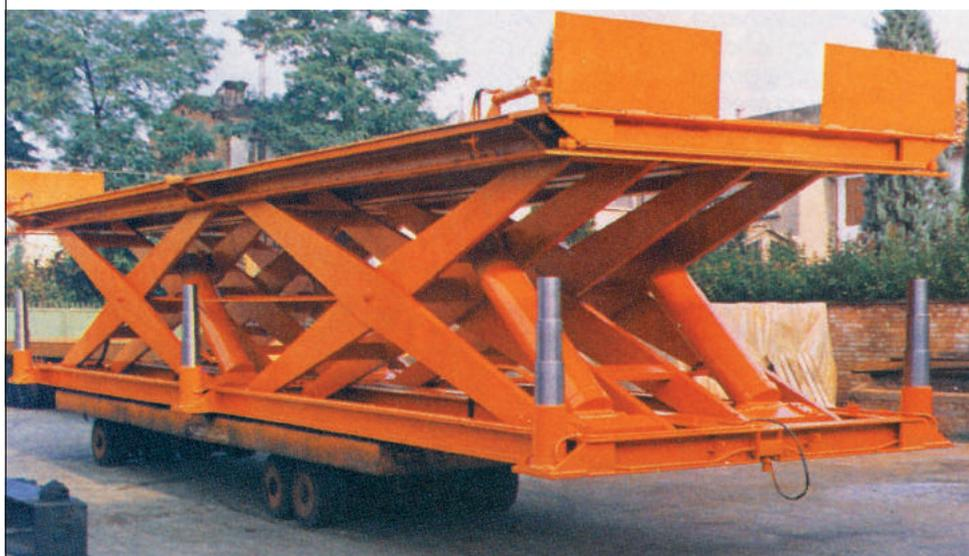
Piattaforma di grandi dimensioni, elevazione e portata con pedana di raccordo e cilindri di presollevario.
