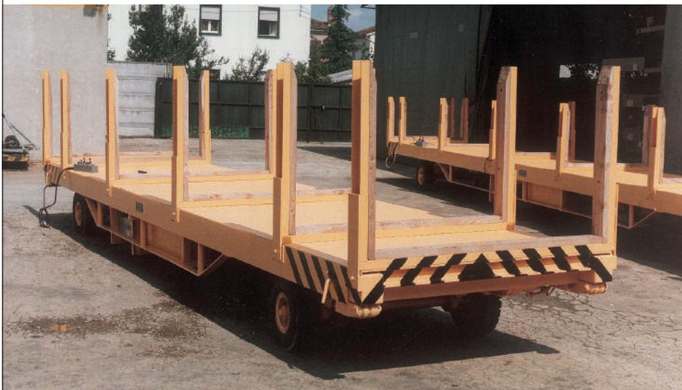
Semovente a batteria con sterzata idraulica e comandi su pulsantiera mobile.
