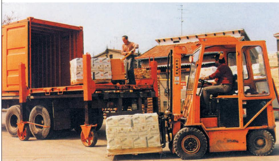
Pedana di carico per container o camion su colonne con ruote, trainabile o autonoma, posizionamento idraulico manuale o con centralina elettroidraulica.
