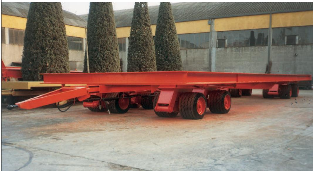
Rimorchio di grande portata su ruote semipneumatiche con sospensioni autocompensate idrauliche e autocaricante con impianto da motrice o autonomo.
