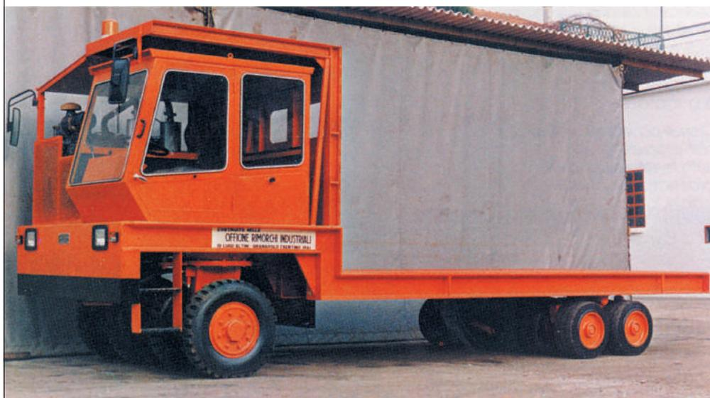
Semovente diesel a trazione idrostatica con pianale di carico ribassato.
