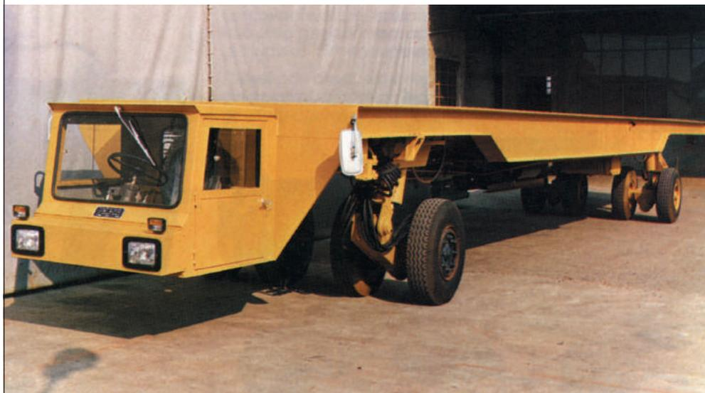
Semovente diesel trazione idrostatica autocaricante.
