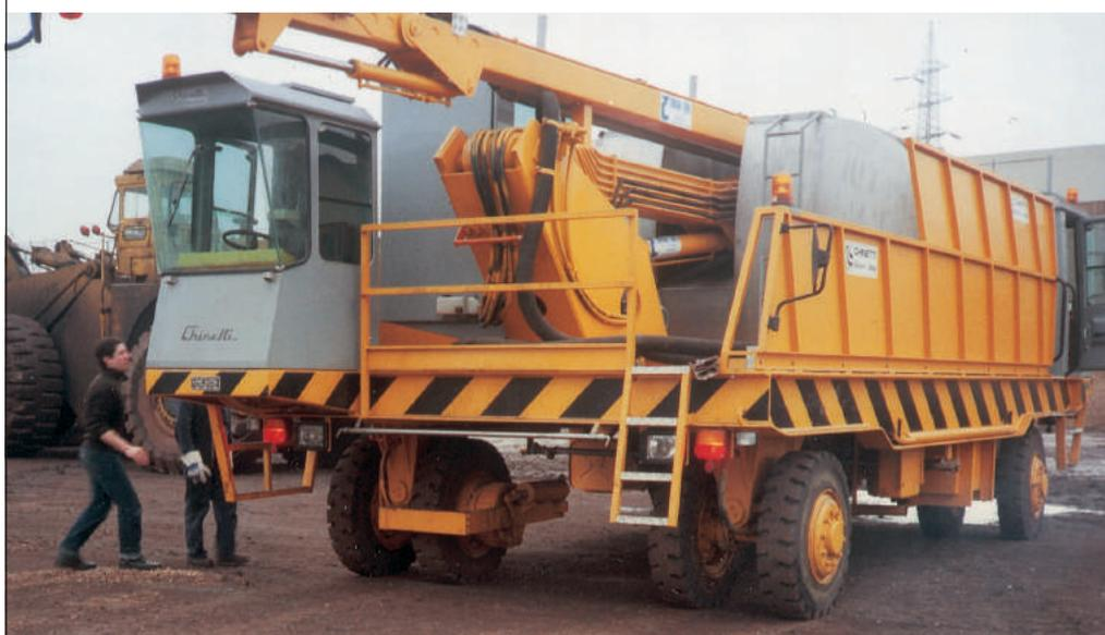
Semovente diesel trazione idrostatica doppia cabina bidirezionale con impianto speciale per irrigazione parchi minerali di acciaieria, traslazione anche trasversale.
