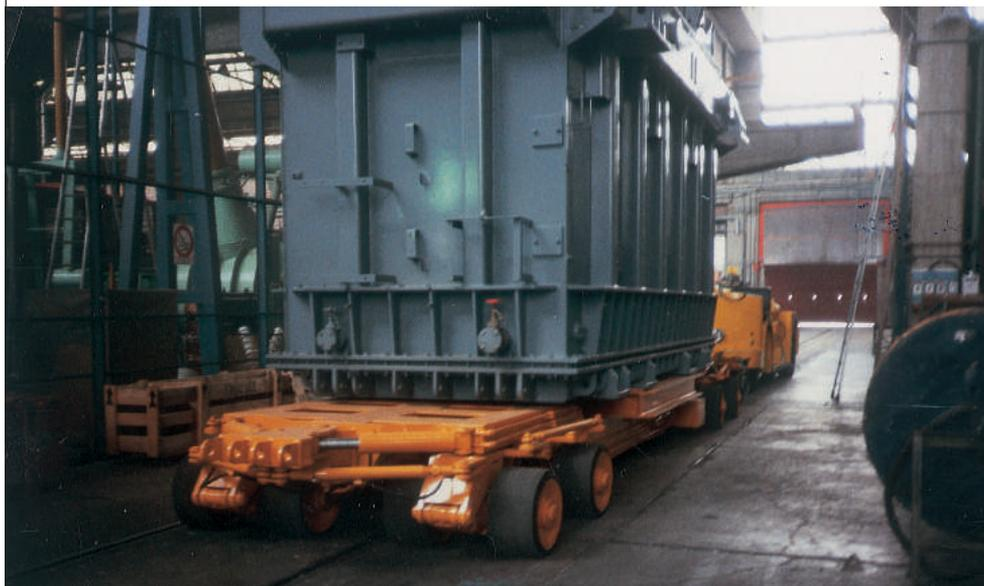
Carrello di grande portata con sospensioni autocompensate idrauliche – autocaricante a pianale ribassato con piano superiore rotante idraulicamente – impianto idraulico autonomo o asservito da motrice.
